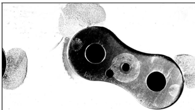
*Рисунок 24 - Выкрашивание и сколы матрицы из стали X12M*
