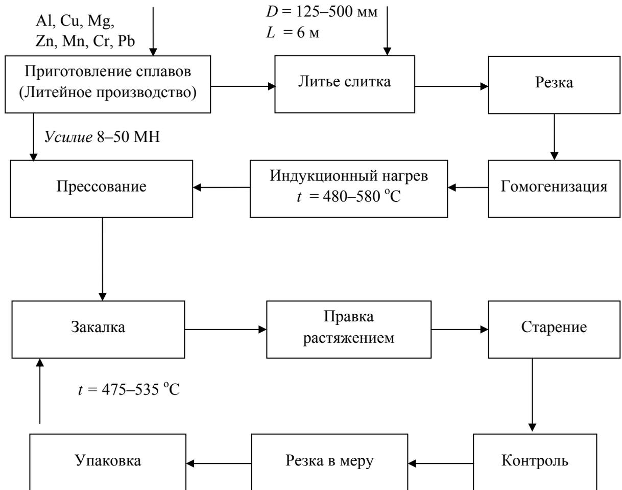
Рис. 14. Типовая технологическая схема прессования
