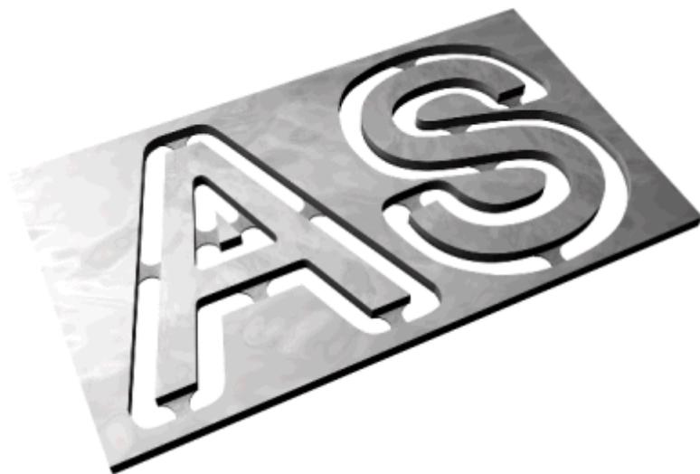
Режущий инструмент, использующийся для обработки по профилю векторного эскиза, слегка приподнимается в направлении Z в месте каждой перемычки, оставляя небольшие опоры, которые удерживают векторный эскиз в нужном положении при обработке. Обработанный векторный эскиз затем может быть аккуратно изъят из заготовки.
